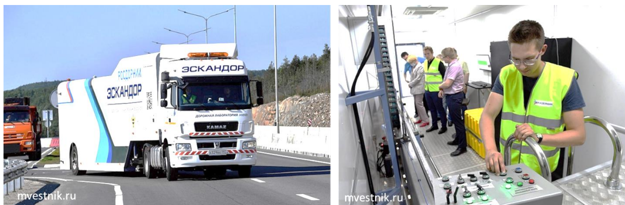
Рисунок 12.6 - Передвижная автолаборатория «Эскандор» проверяет прочность автомобильных дорог в Мурманской области 294
