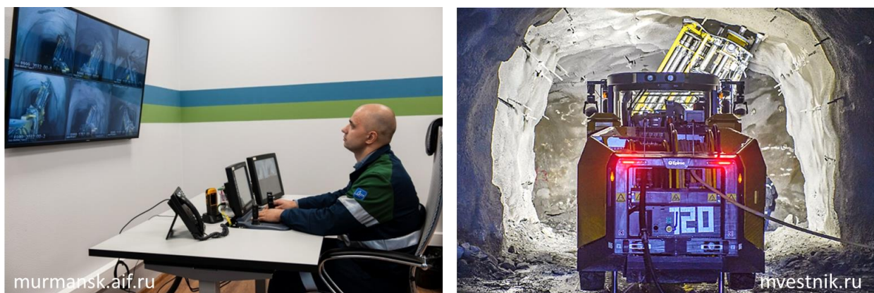
Рисунок 12.3 - На Расвумчоррском руднике АО «Апатит» внедрена технология дистанционного бурения 256
